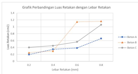
Gambar 13 Grafik Hubungan Lebar Retakan dengan Luas Retakan
