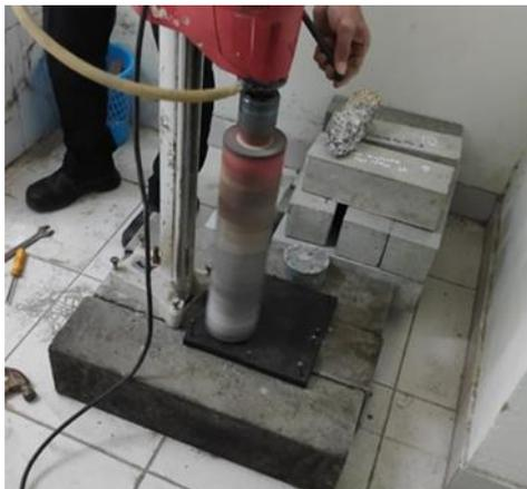
Gambar 8 Proses Coring pada Karet Pejal
