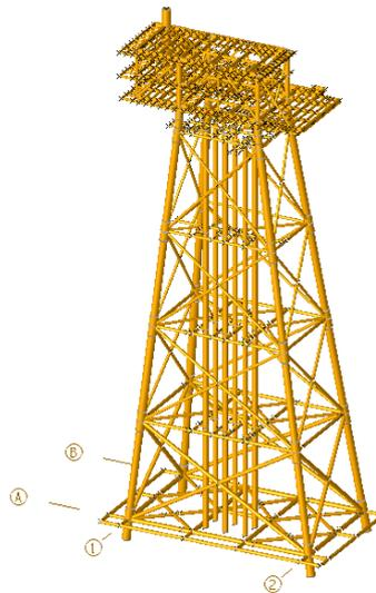
Gambar 4 Model Struktur untuk *Inplace*, Badai, *Fatigue*, dan Gempa pada SACS 5.3
