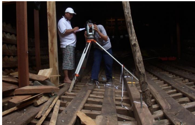
Gambar 7. Pengukuran Geometri Kapal Layar Motor KM 31
