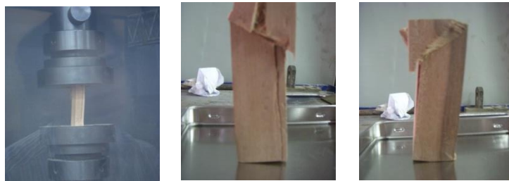
Gambar 9. Pengujian Spesimen Kayu Bitti
