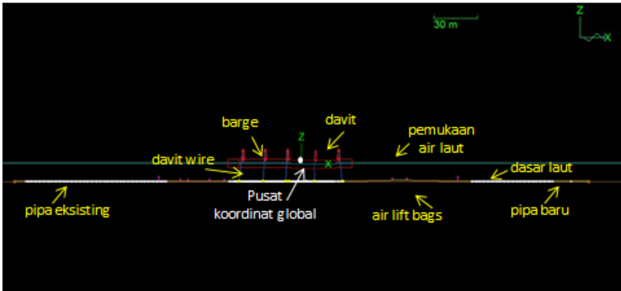
Gambar 6 Hasil pemodelan OrcaFlex (tampak samping)
