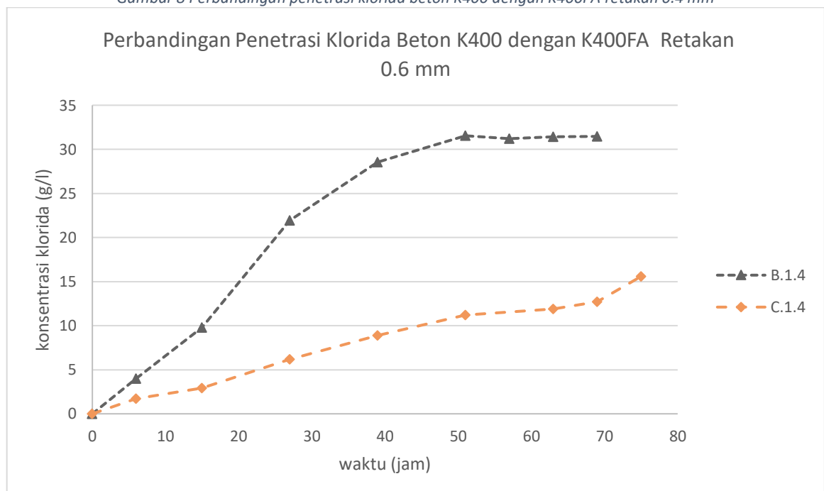
Gambar 9 Perbandingan penetrasi klorida beton K400 dengan K400FA retakan 0.6 mm
