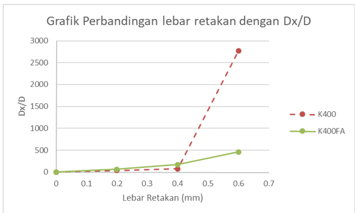
Gambar 12 Grafik Perbandingan lebar retakan dengan D_x/D
