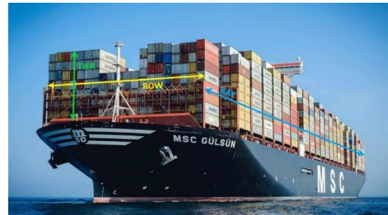
Gambar 4 Sistem Penempatan Peti Kemas di Kapal.
