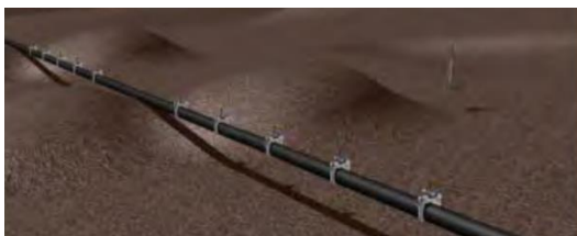
Gambar 3 Ilustrasi bentang bebas ( free span ) pipa bawah laut
