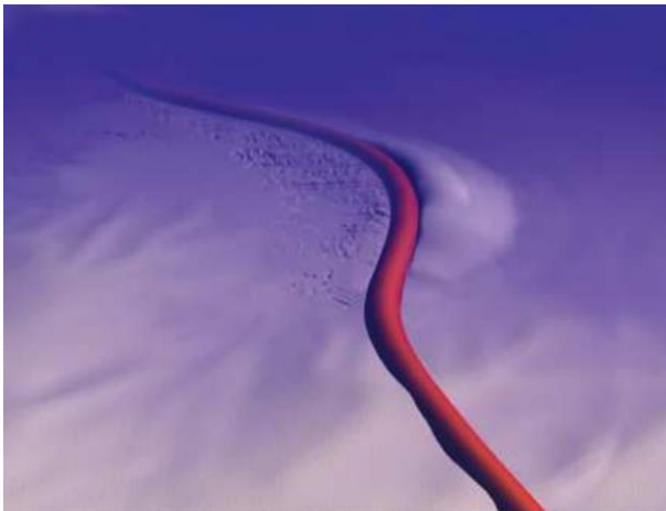
Gambar 2 Lateral Buckling pada Pipa Bawah Laut (Craveiro, 2017)
