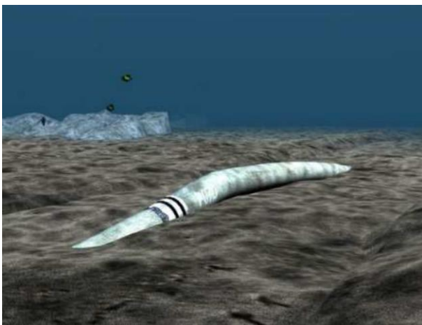
Gambar 3 Upheaval Buckling pada Pipa Bawah Laut (Craveiro, 2017)
