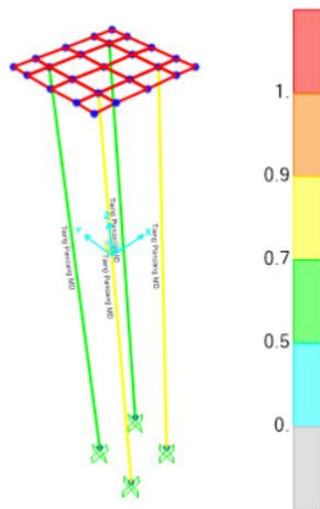
Gambar 14 Hasil UCR Struktur Mooring Dolphin
