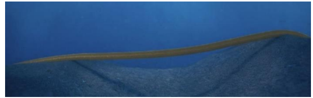
Gambar 3 Ilustrasi bentang bebas (free span) pipa bawah laut
