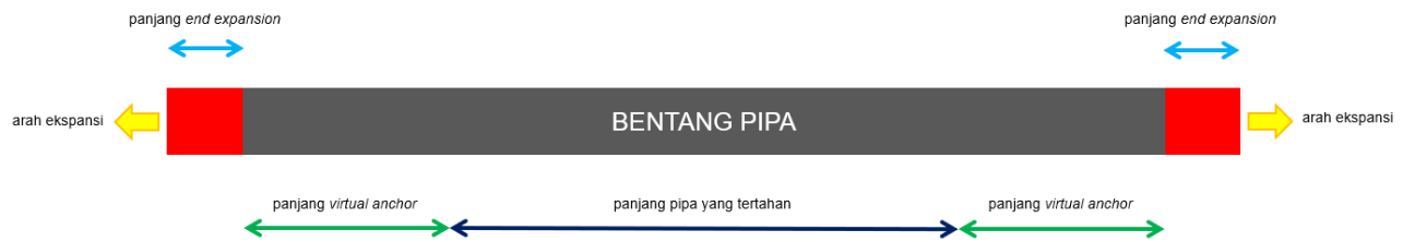
Gambar 4 Ilustrasi end expansion yang terjadi sepanjang pipa.
