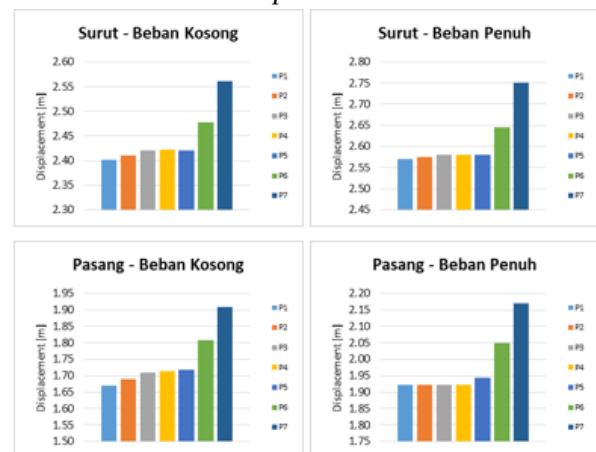
Gambar 38 Grafik perpindahan maksimum arah resultan keadaan dinamis kondisi damaged
