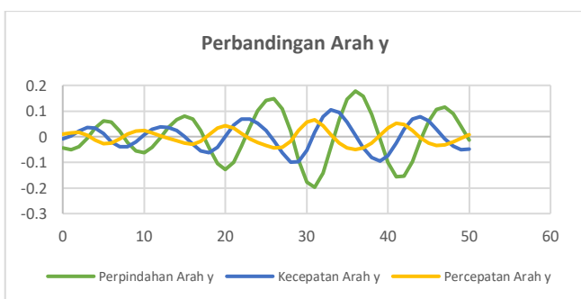
Gambar 12: Grafik Perbandingan Arah y Akibat Gelombang Acak dari Selatan pada Kasus Intact saat Kondisi Storm
